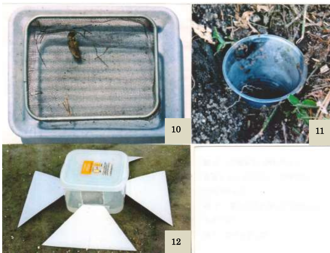
図 10. 土壌ふるい用のざるとトレイ。落葉層をざるでふるい、昆虫他の土壌動物をトレイに落下させる。
